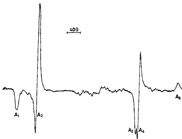
Fig. 2. Spectre RPE. obtenu avec une poudre de diphénylthiophosphine irradiée
